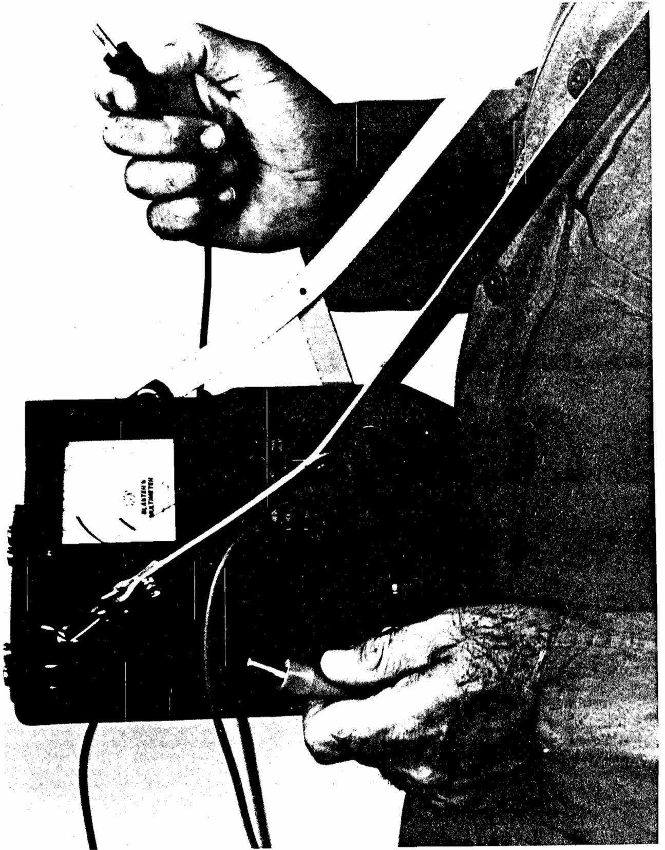
Figure 27.—Blasting multimeter. (Courtesy Du Pont Co.)
