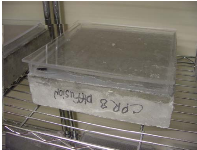
Photo 6.5.4.1-1 - AASHTO T-259 Diffusion Test to evaluate durability.
