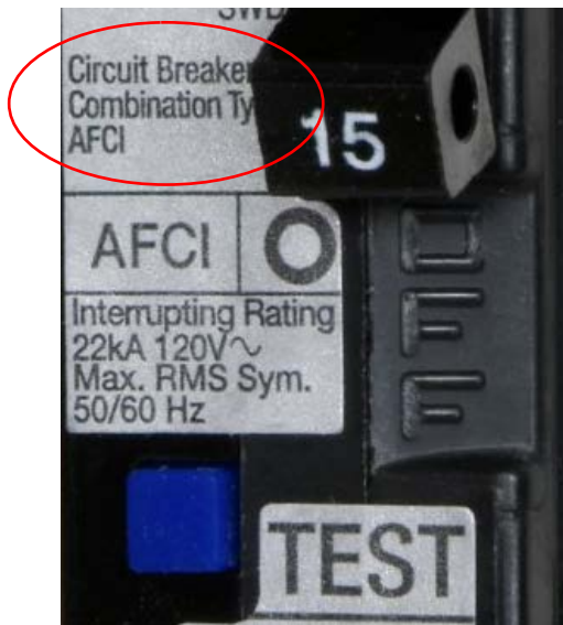
Siemens Q115AFC 15-amp, 1 pole, 120-volt combination- type AFCI
