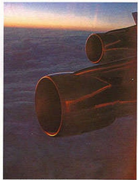
四台美国普拉特惠特尼公司的JT9D-7型发动机，单台推力超过20,000公斤。 Equipped with four Pratt & Whitney JT9D-7 engines, each with a thrust of over 20,000 kilograms.
